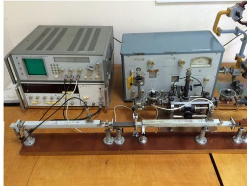
Рис. 4. Панорамный измеритель КСВН и ослабления P2-61
